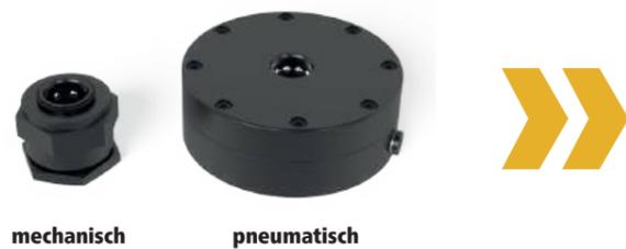
Das Nullpunktspannsystem ist in zwei Ausführungen erhältlich. Die mechanische Variante wird mittels eines Gabelschlüssels gespannt bzw. geöffnet. Bei der pneumatischen Variante wird der Spanbolzen mittels Druckluft gelöst. Ohne Zufuhr von Druckluft ist der Bolzen gespannt.
