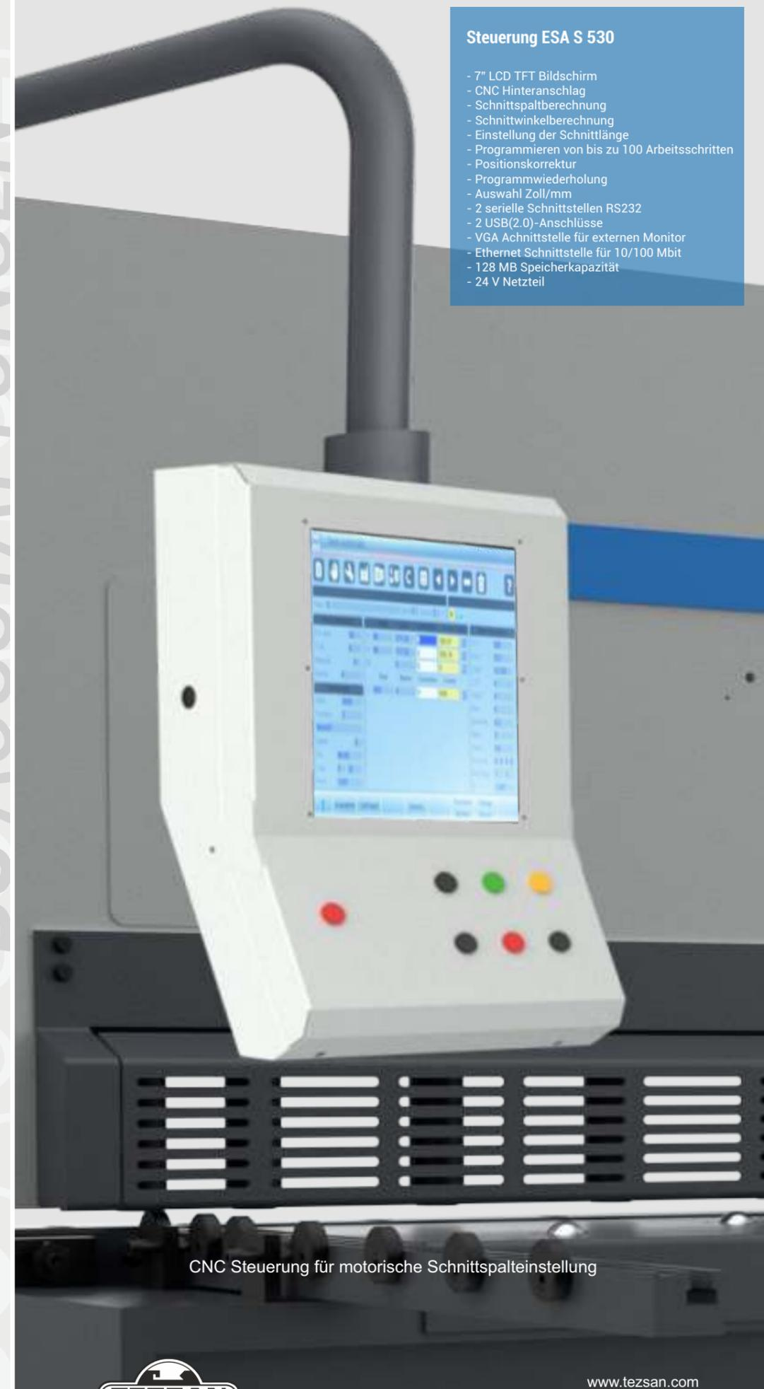
CNC Steuerung für motorische Schnittspalteinstellung
