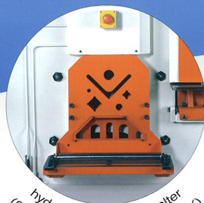
U-Stahl ausklinken bei der IW-85KD
