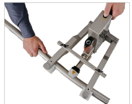
Biegen von Rohr 42 mm
