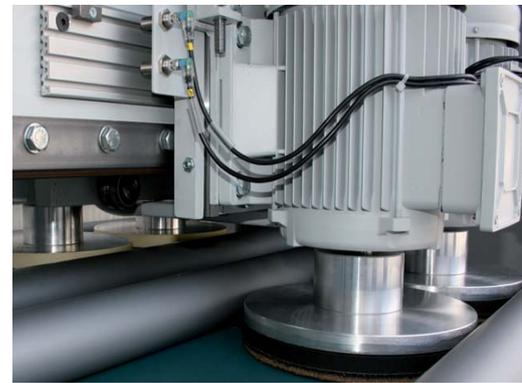
Vier rotierende und oszillierende Discs für 360° Bearbeitung
