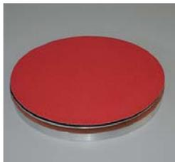
Gebrauchsmustergeschützte **Combidisc**, per Klettbelag bestückt mit Schleifscheiben. Zum Entgraten starker Grate bis 3mm Höhe und Entfernen von Spritzern, insbesondere bei Edelstahl.
