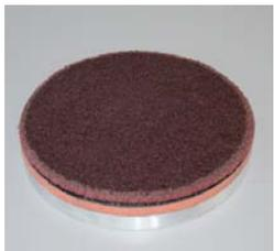
**Softdisc** mit weichem Pad, per Klettbelag bestückt mit harten Vliesscheiben. Zum Entgraten von Alu oder Stahl, aggressiv an den Kanten bei wenig Druck auf den Flächen.
