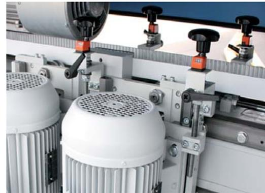
Einzel verstellbare Discs zur einfachen Kompensation unterschiedlicher Werkzeugdicken
