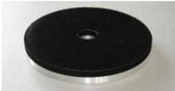
**SoftDisc:** Ideal zum entgraten von Laserteilen aus Aluminium oder zum leichten entgraten von Stahlteilen. Die weiche SoftDisc ist fehlertolerant und erzielt viel Druck auf der Kante bei wenig Erwärmung des Werkstückes. Perfekt geeignet für die Kleinteilbearbeitung.
