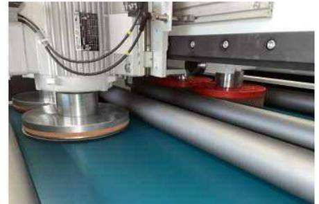
Vier rotierende und oszillierende Discs für 360° Bearbeitung
