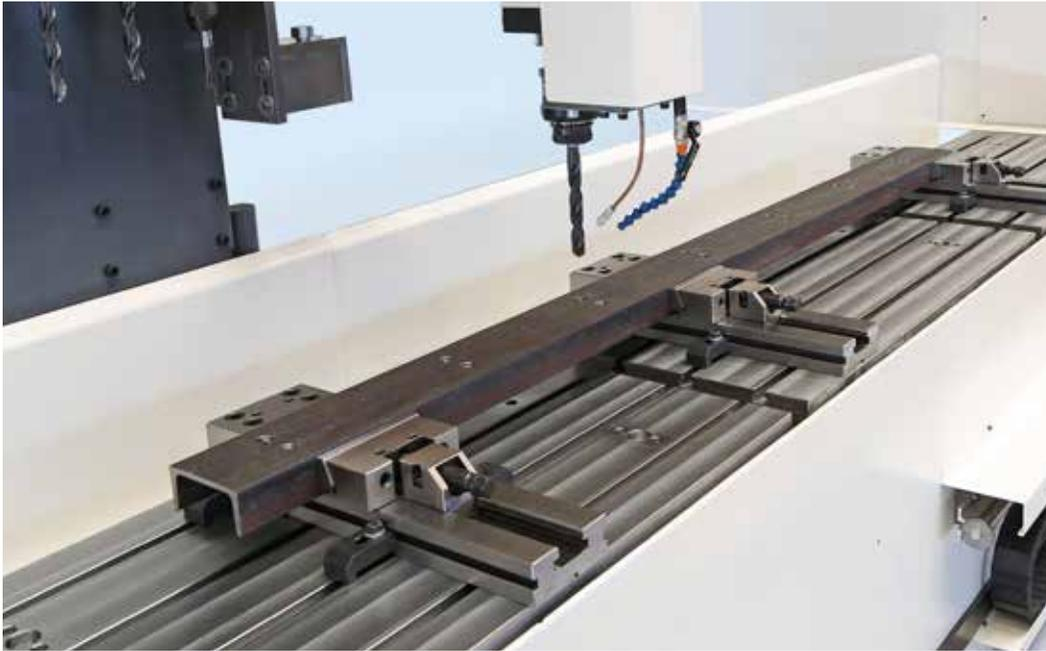
Aufspannbeispiel von langen Teilen durch mehrere Schraubstöcke
