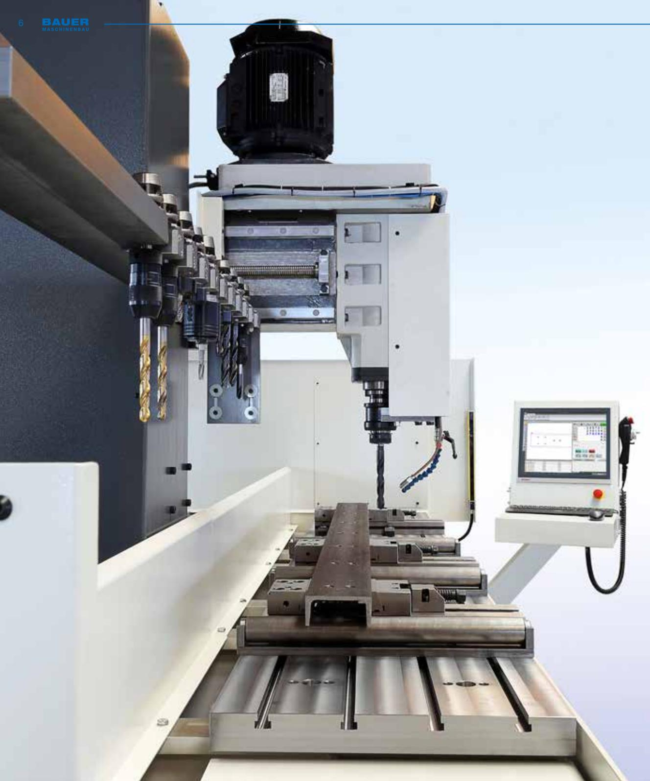
Materialspannung durch 3 Schraubstöcke, Rollenböcke zum leichteren Materialtransport in der Maschine, Bedienpult verschiebbar und drehbar, Handeinstellgerät, Werkzeugwechsler für 10 Werkzeuge
