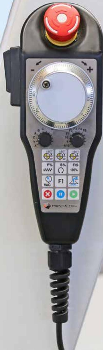
Handbediengerät zum leichteren Einstellen der Nullpunkte an der Maschine.
