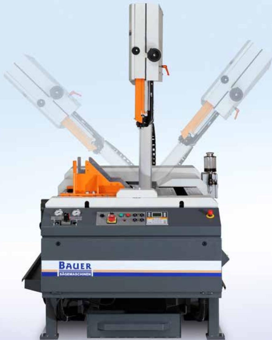
Wenn beidseitige Gehrungsschnitte gefordert sind, ergeben sich deutliche Vorteile der vertikalen Gehrungsbandsägen gegenüber den horizontalen Bandsägemaschinen.
