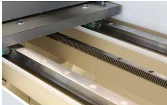
Groß dimensionierte Linearführungen, großer Führungsabstand, Vorschub x-Achse durch geschliffene Schrägverzahnte Zahnstange, Servogetriebe und Servomotor
