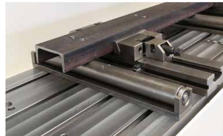
Zum leichteren Verschieben der langen Werkstücke bietet BAUER Rollenböcke an
