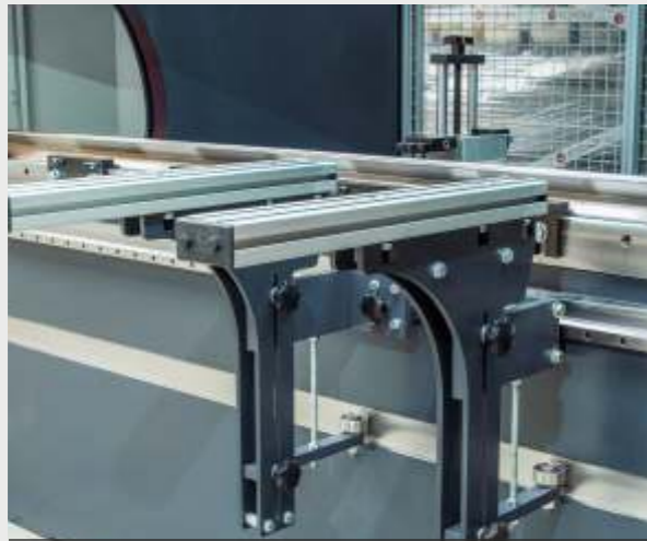
Auflagearm leichte Ausführung <135 to Presskraft
