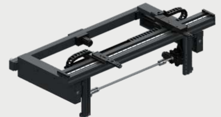
X, R, Z1, Z2, XPrime Achsen (servomotorisiert)
