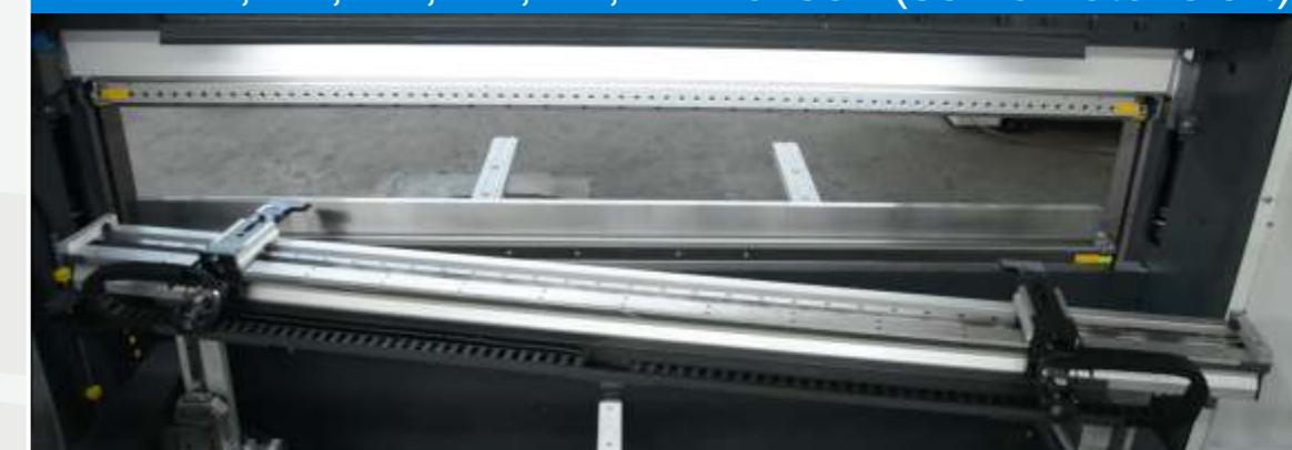
X1, X2, R, Z1, Z2, XPrime Achsen (servomotorisiert)
