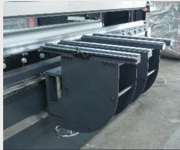
Auflagearm schwere Ausführung >135 to Presskraft
