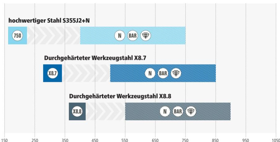
Eine hohe Grundhärte ist entscheidend für eine hohe Schlagfestigkeit und die lange Lebensdauer eines Schweißbisches. Durch die anschließende Plasmanitrierung und BAR-Beschichtung erfolgt eine Oberflächenveredelung, die das Material härtet und vor Kratzern, Korrosion und Schweißperlenanhaftung schützt. Nur durch die Kombination aus hoher Grundhärte und Plasmanitrierung ergibt sich eine verschleißarme und langlebige Oberfläche.
